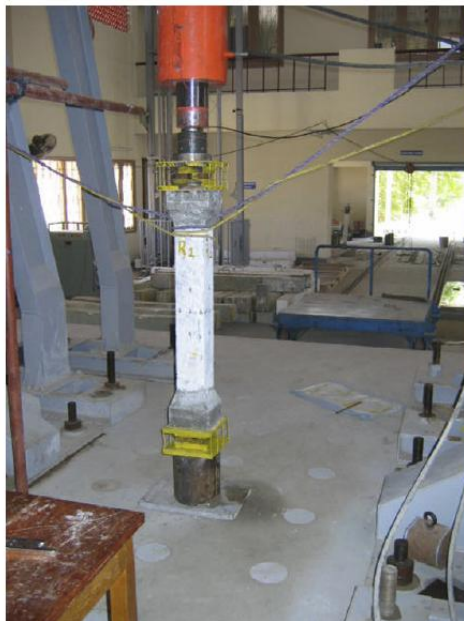
الشكل (24-2): توضع العينة ضمن جهاز الاختبار [12]
