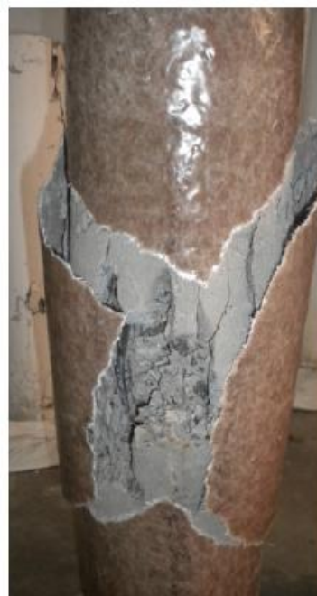
الشكل (16-2): شكل الانهيار للعمود البيتوني المغلف
