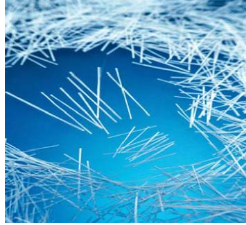
الشكل (8-1) الألياف الزجاجية بشكل خيوط منفصلة [18] الشكل (9-1) الألياف الزجاجية بشكل لفافة مستمرة [18]
