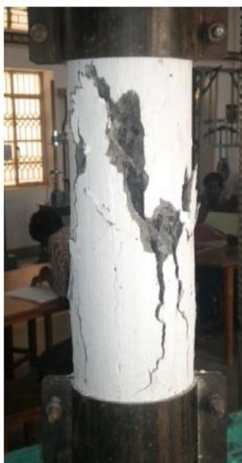
الشكل (17-2): شكل الانهيار للعمود البيتوني
