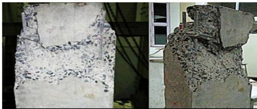
الشكل (2-34): انهيار العمود المستطيل غير المغلف [13]
