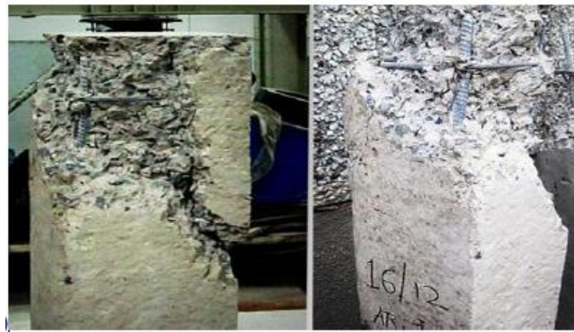
الشكل (2-33): انهيار العمود المربع غير المغلف [13]
