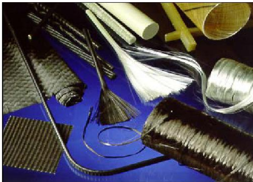
الشكل (1-7): بعض أنواع وأشكال مركبات ال FRP المستخدمة في صناعة البناء والتشييد [18]
