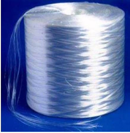
الشكل (8-1) الألياف الزجاجية بشكل خيوط منفصلة [18] الشكل (9-1) الألياف الزجاجية بشكل لفافة مستمرة [18]
